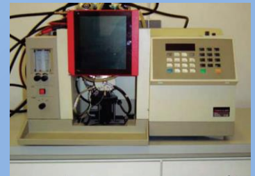
Atomski apsorpcijski i emisijski spektrometar
