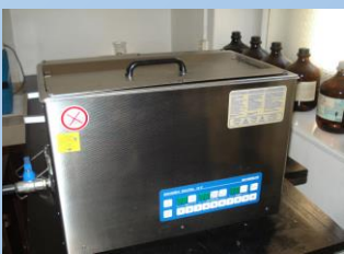
Uređaj za ultrazvučnu ekstrakciju
