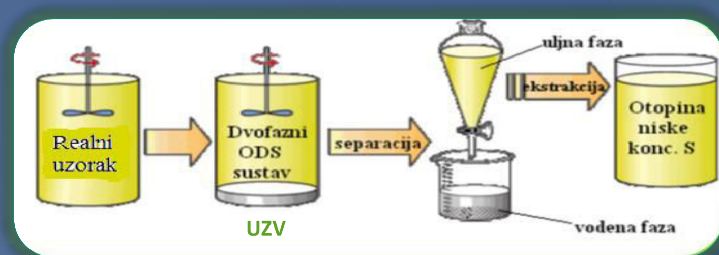
Slika 5. Shematski prikaz procesa oksidacijske desulfurizacije
