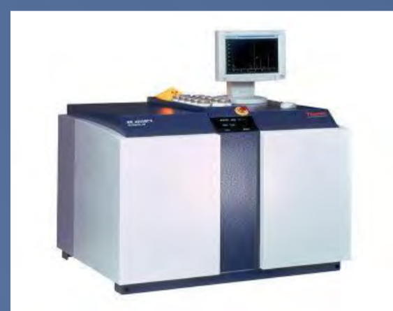
Slika 4. Instrument THERMO ARL WD-XRF ADVANT X 25 (INA d.d.) – analiza ukupnog sumpora u uzorcima
