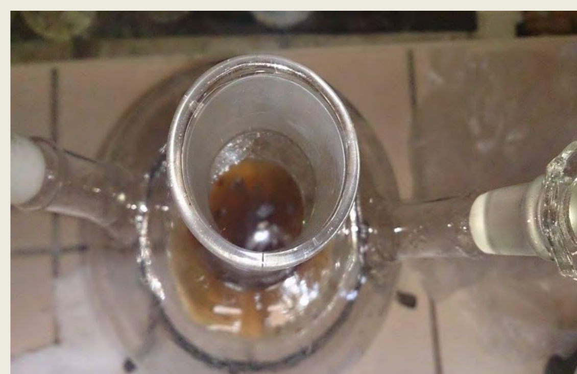
Slika 6. Početak redukcije GO u rGO
