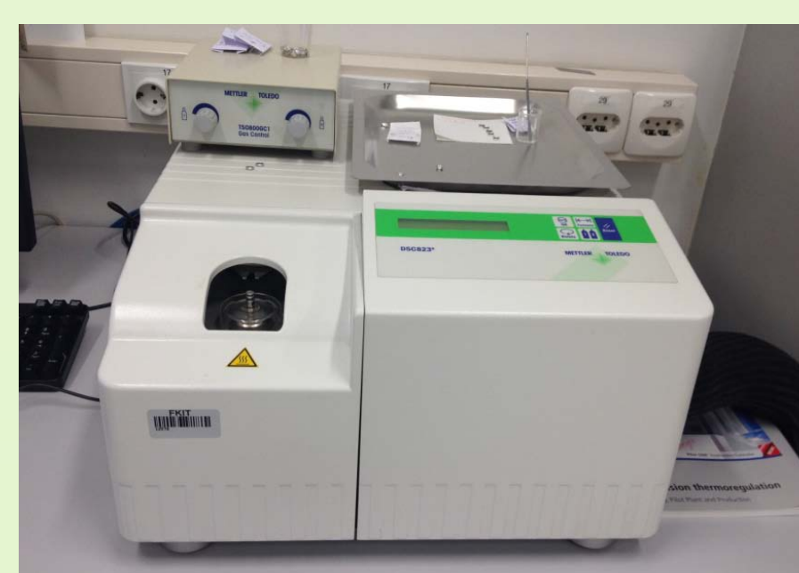
Slika 2. Diferencijalni pretražni kalorimetar Mettler Toledo DSC823 e
