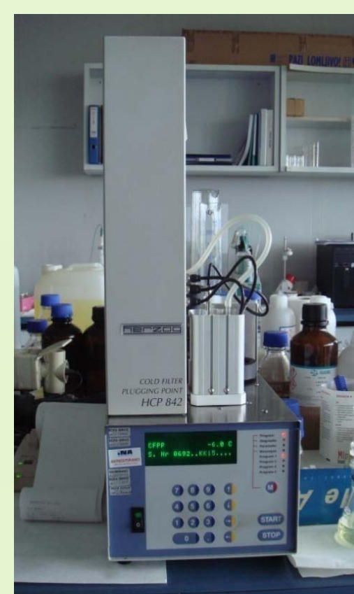
Slika 1. Automatski analizator za određivanje točke filtrabilnosti (Herzog HCP 842)
