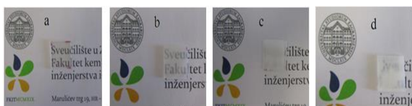
Slika 8 Usporedba prozirnosti uzoraka prije te nakon bubrenja: a) uzorka koji nije bubren b) voda c) toluen d) ksilen
