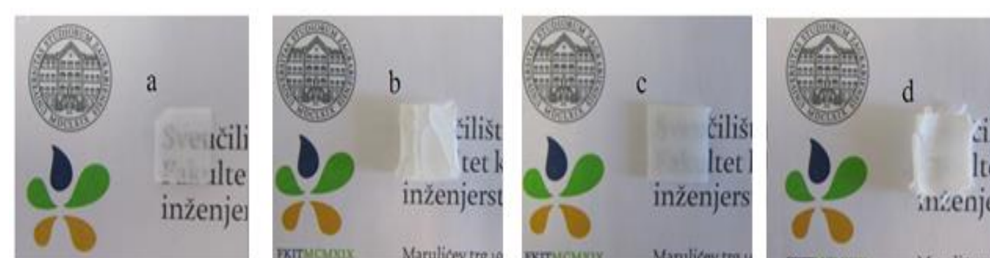
Slika 9 Prikaz prozirnosti uzoraka bubrenih u sljedećim otapalima: a) THF b) aceton c) DMSO d) DMF
