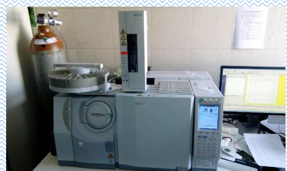
Slika 3. Plinski kromatograf GC-MS-QP2010 Ultra sa spektrometrom masa
