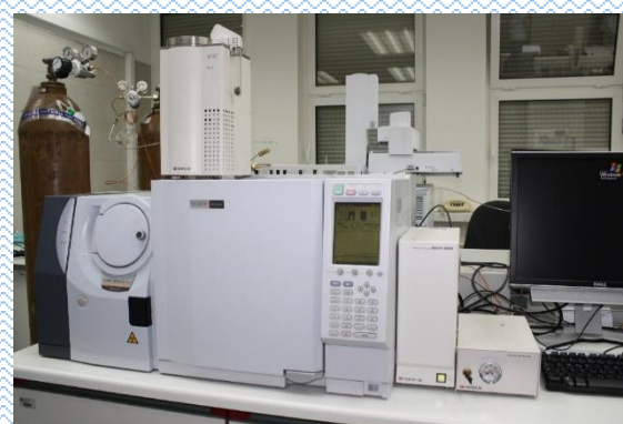
Slika 1. Pirolytička jedinica EGA/Py-3030D povezana s GC-MS-QP2010
