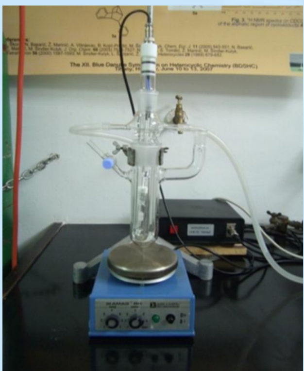
Slika 2. Aparatura za provođenje fotokatalitičke oksigenacije
